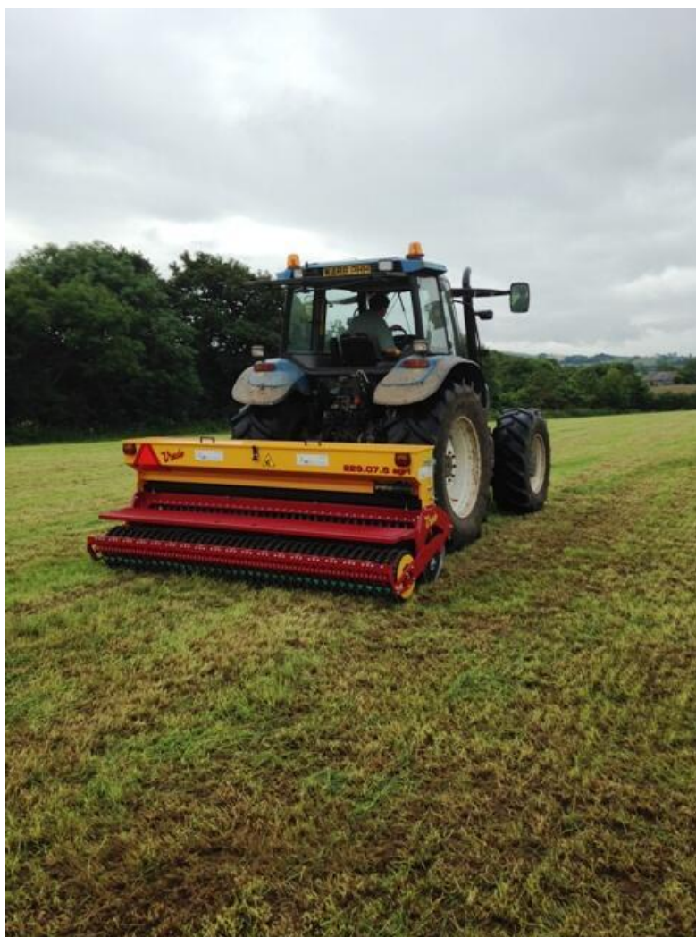
Zdj. 1 Agregat nacinający darń redlicami szczelinowymi
