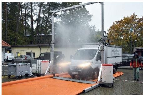
Przejazdowa brama dezynfekcyjna, wraz z pompowa- ną wanną dezynfekcyjną (źródło: WMODR)
