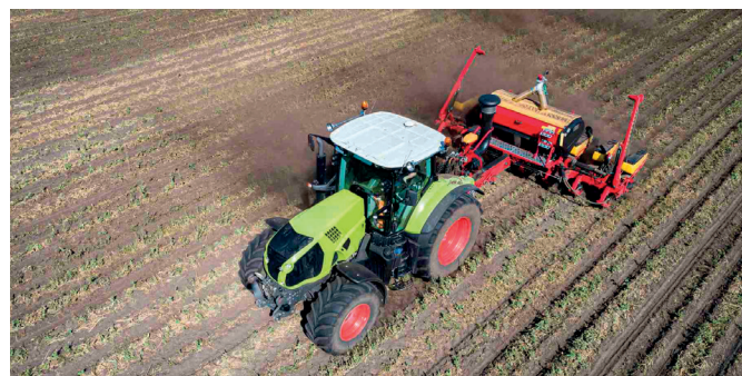
Zestaw ciągnika z siewnikiem podczas siewu kukurydzy w technologii strip-till.
